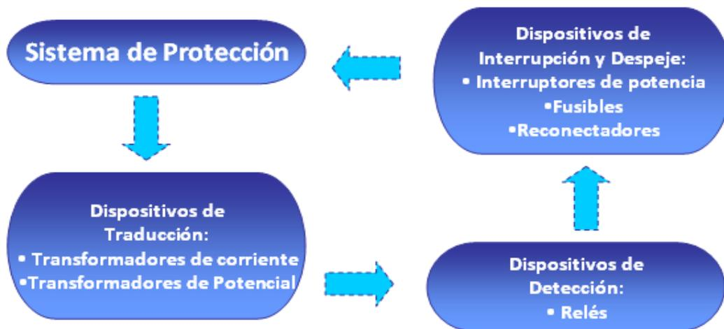
**Figura. 2.11. Diagrama de bloques representativo de un sistema de Protección.**
